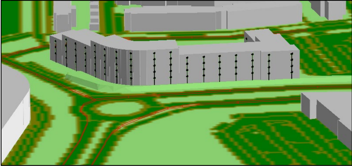
Figuur 3.1 Ruimtelijke (3D) weergave van het rekenmodel met toetspunten
