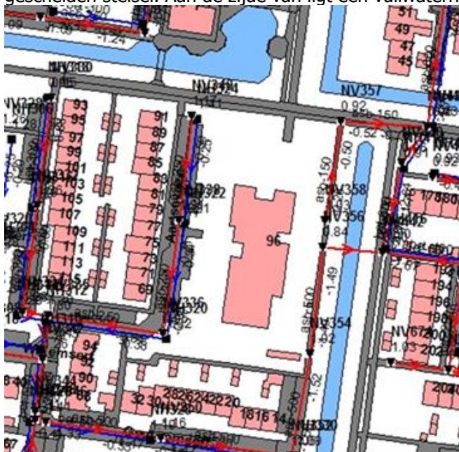
Afbeelding 3.3: Overzicht riolering (bron: gemeente Eemnes)
