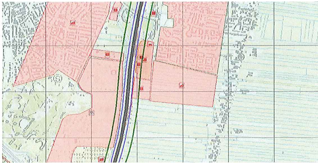
Figuur 4.1 PR-contouren bij transportcijfers 2010. De groene contour om de wegen is de 10^{-8} risicocontour. De donkerblauwe lijn om de weg is de 10^{-7} risicocontour.
