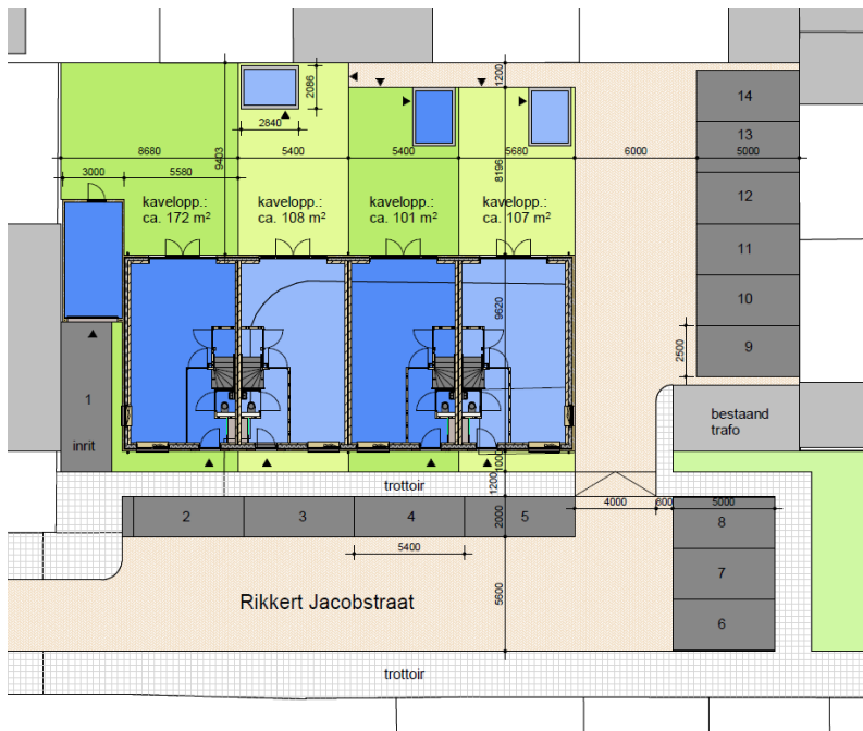
Afbeelding: aangeven aantal parkeerplaatsen
