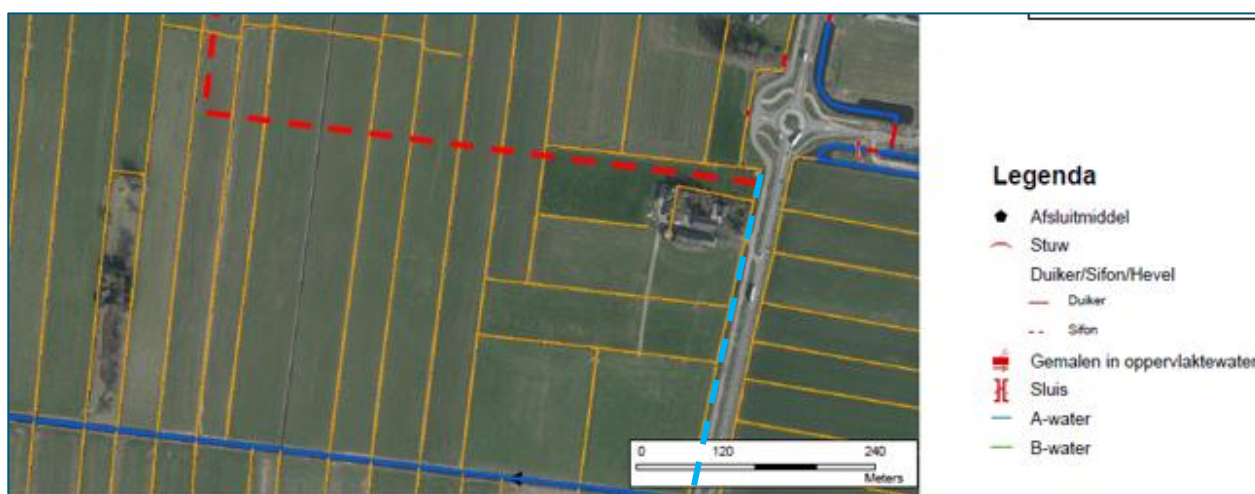
Figuur 4.3: Beoogd tracé A-watergang die De Kronkels Zuid verbindt met Haarse Wetering
