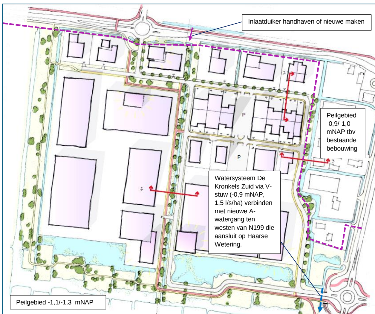
Figuur 4.2: Watersysteem plansituatie De Kronkels Zuid
