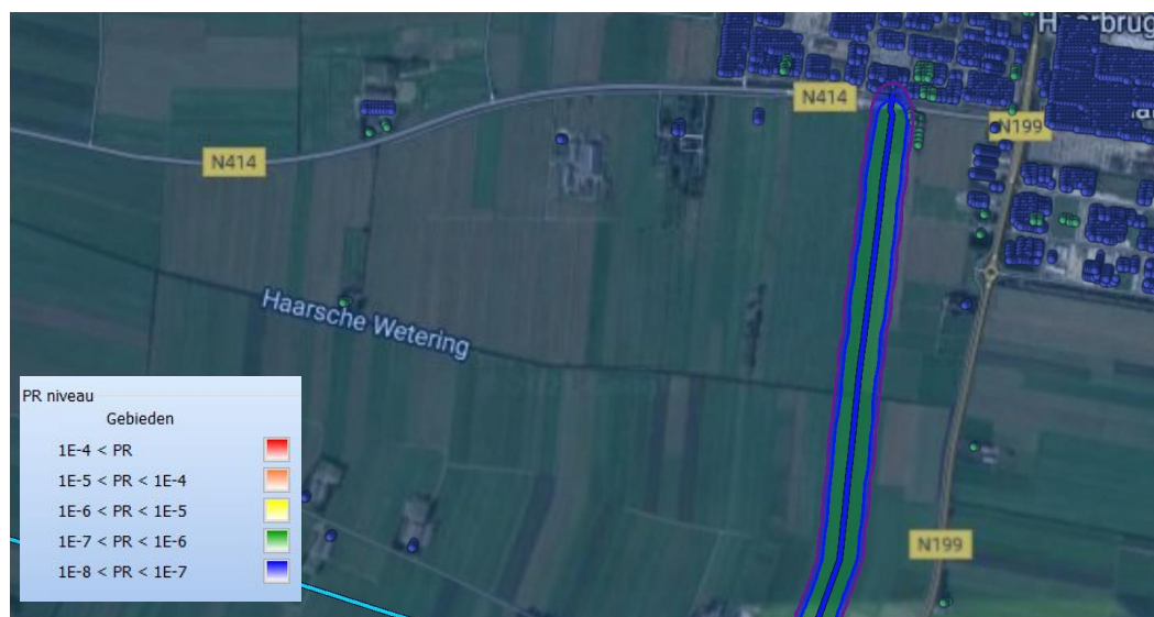
Figuur 4.2 PR contouren voor 7389_leiding-W-500-05-deel-1 van N.V. Nederlandse Gasunie
