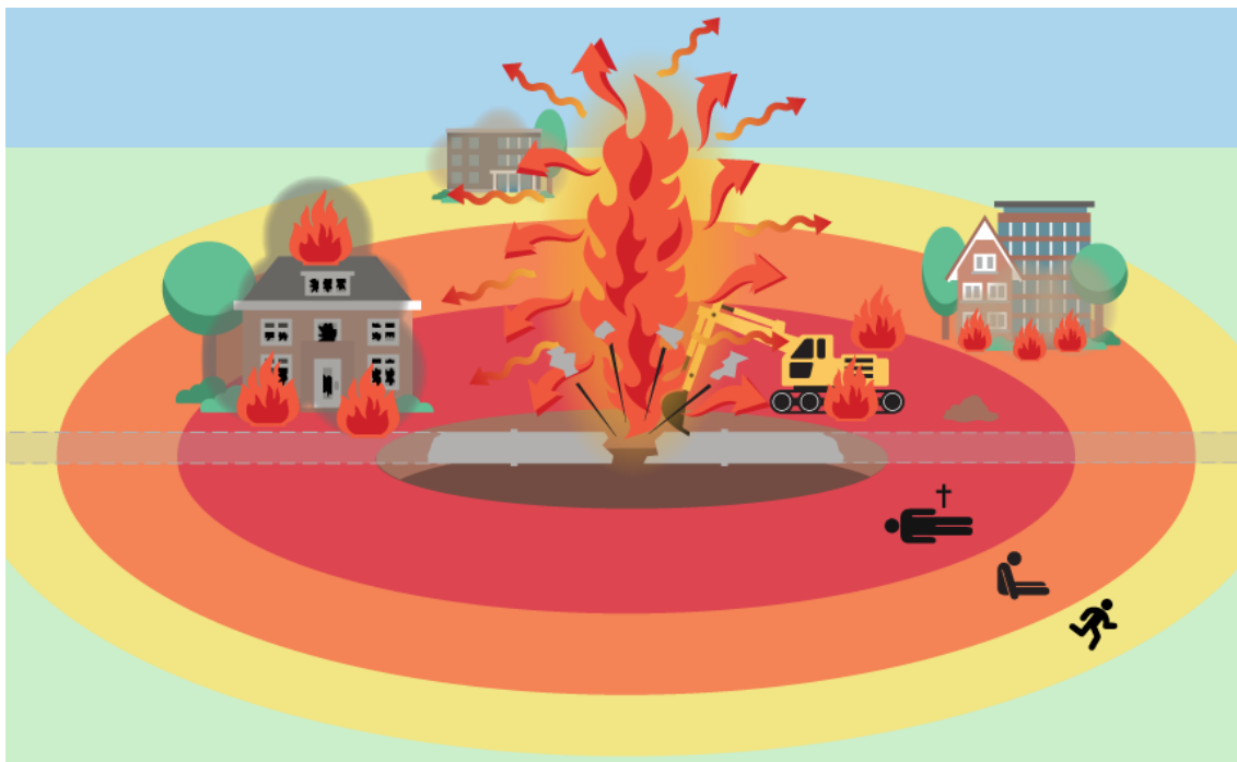
Figuur 3: Handelingsperspectieven bij een fakkelbrand in een hogedruk aardgasleiding (bron: scenarioboek EV, geraadpleegd 20-10-'21).
