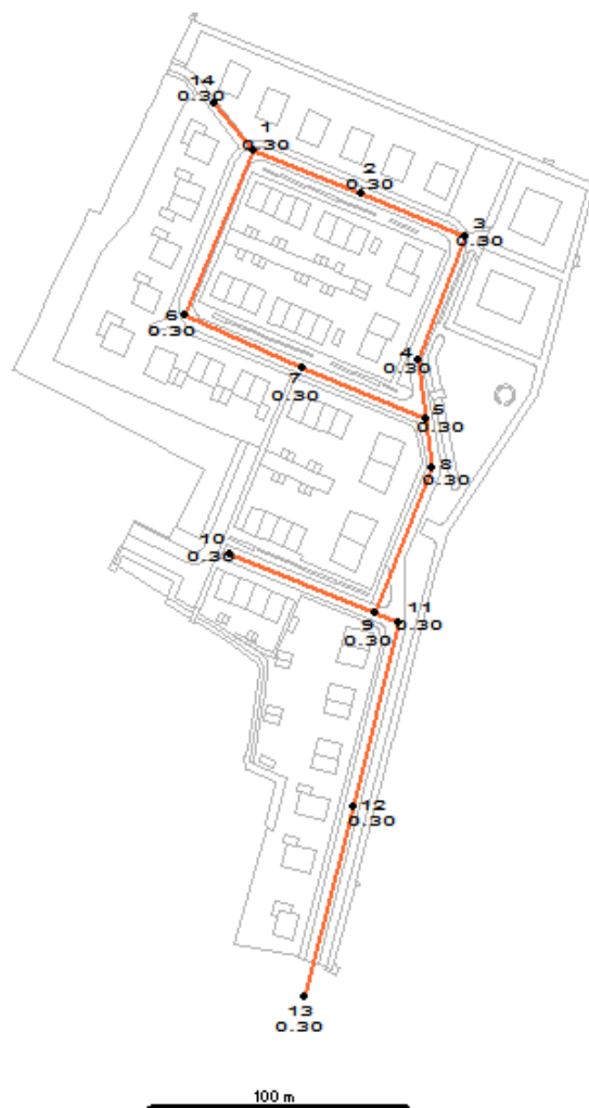
Figuur 1: schematisch overzicht ontworpen dwa-stelsel
