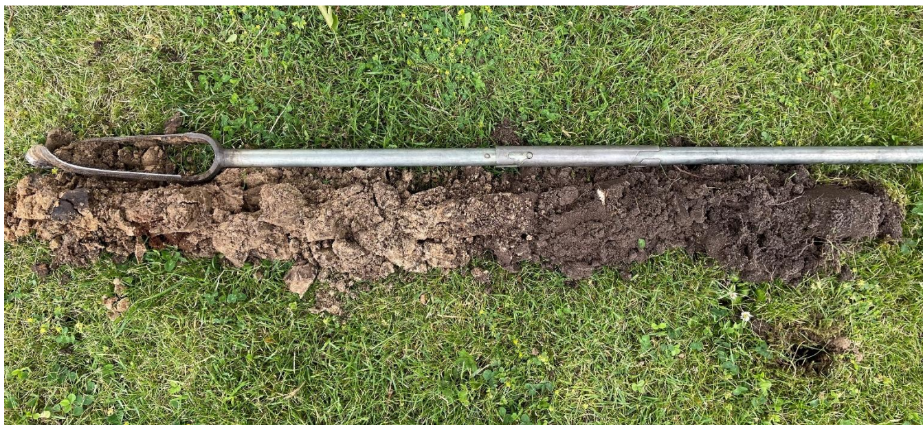
Afb. 8: totaal overzicht boring ca. 120 cm diep buiten rand kroonprojectie linde. (foto Botani Specialist)
