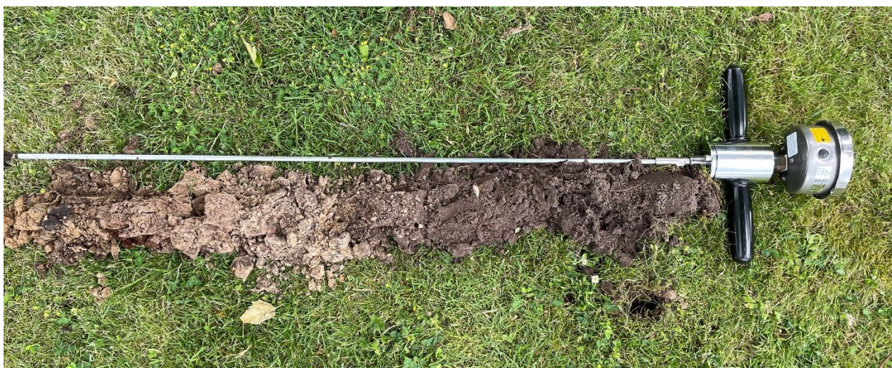
Afb.10: totaal overzicht boring ca. 110 cm diep buiten rand kroonprojectie linde. (foto Botani Specialist)
