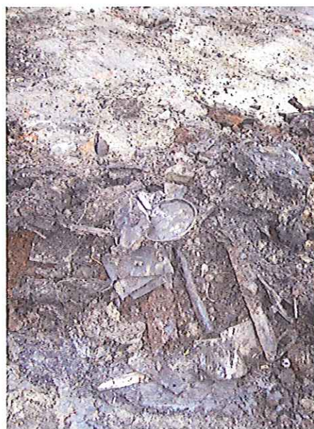
Aangetroffen asbesthoudend stortmateriaal
