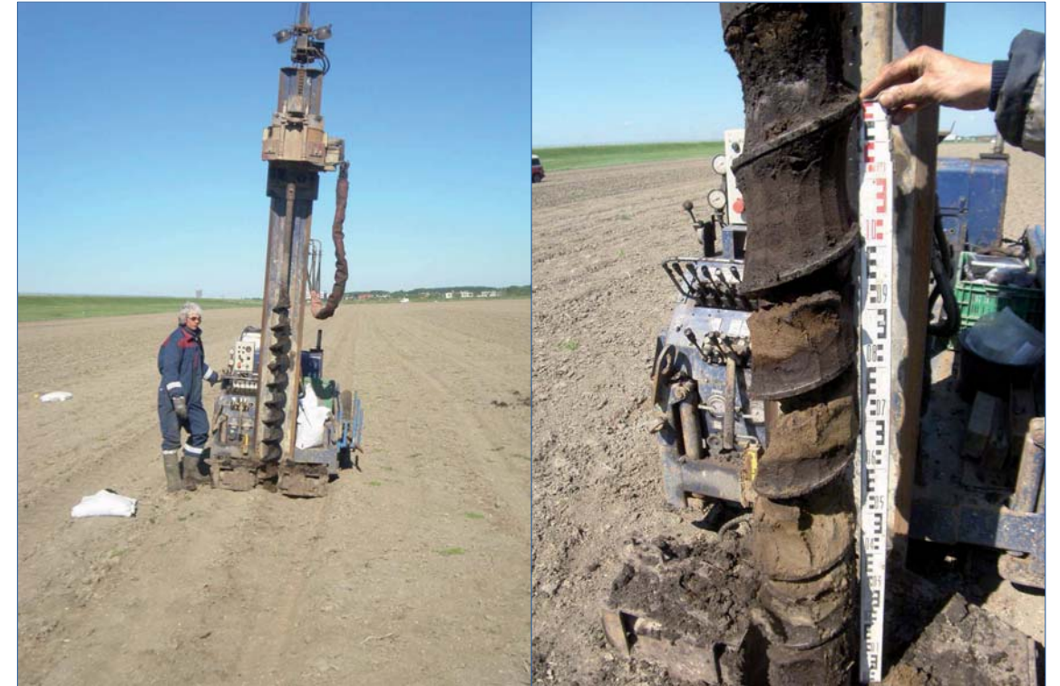
Figuur 8. Veldopstelling van een Wizzard met een Avegaarboor (links); detail van een mechanische Avegaarboor (rechts).
