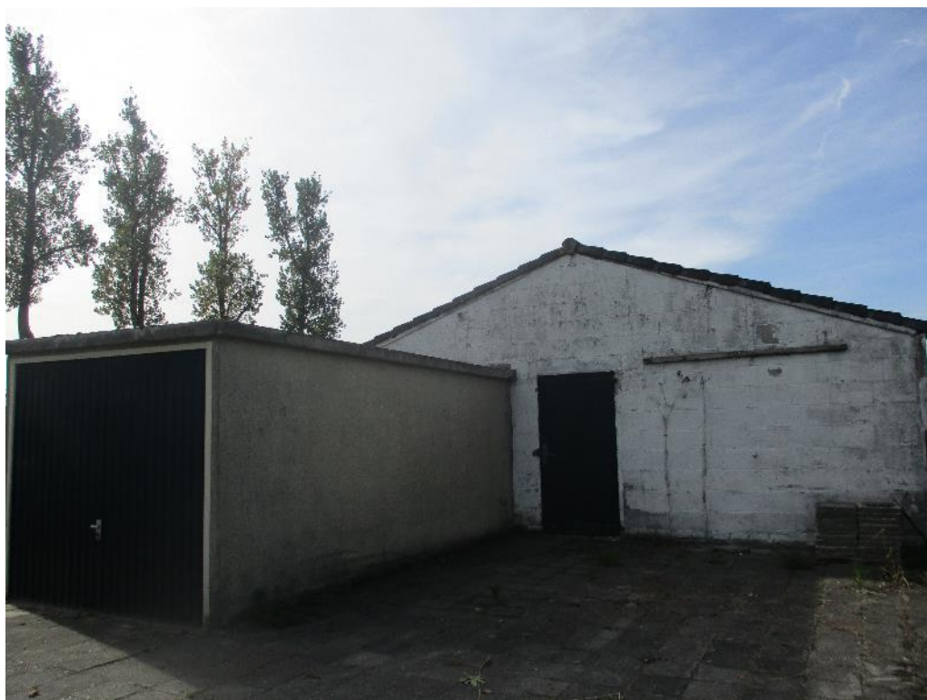
Figuur 1 De planlocatie is gelegen aan de Achterdijk 66b te Werkhoven. Het perceel bestaat uit een voormalige paardenstal met aanbouw. Tevens is er ten zuidoosten van de bebouwing een aantal kuilplaten aanwezig. De voormalige veestal is opgetrokken uit gemetselde cementstenen en een zadeldak met dakpannen. De aanbouw is opgetrokken uit stucwerk en een bitumen dak.
