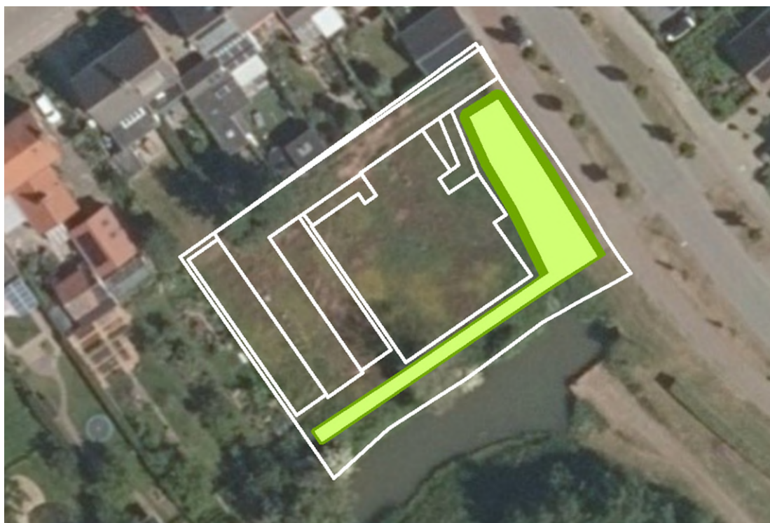
Figuur 4.1 Overzicht hemelwatervoorziening. Licht groen: bodem, donkergroen is talud.
