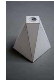
TETRAEDERS BASIS: 40 x 40 CM TOP: 16 x 16 CM 45° GEDRAAID TOV BASIS HOOGTE: 50 CM IN TOPVLAK ZIT EEN KOGELKOPANKER MEEGESTORT
