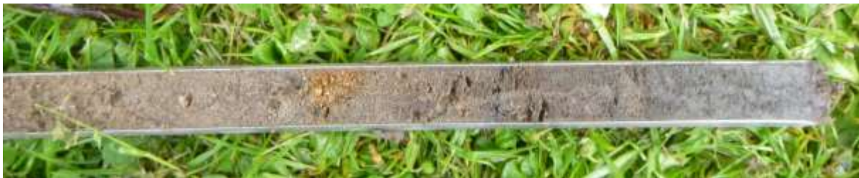
Figuur 19: Het in boring 619 aangetroffen laagje verkoalde plantenresten (rechts van het midden) met links daarvan opgebracht zand en rechts, zwak venige klei.
