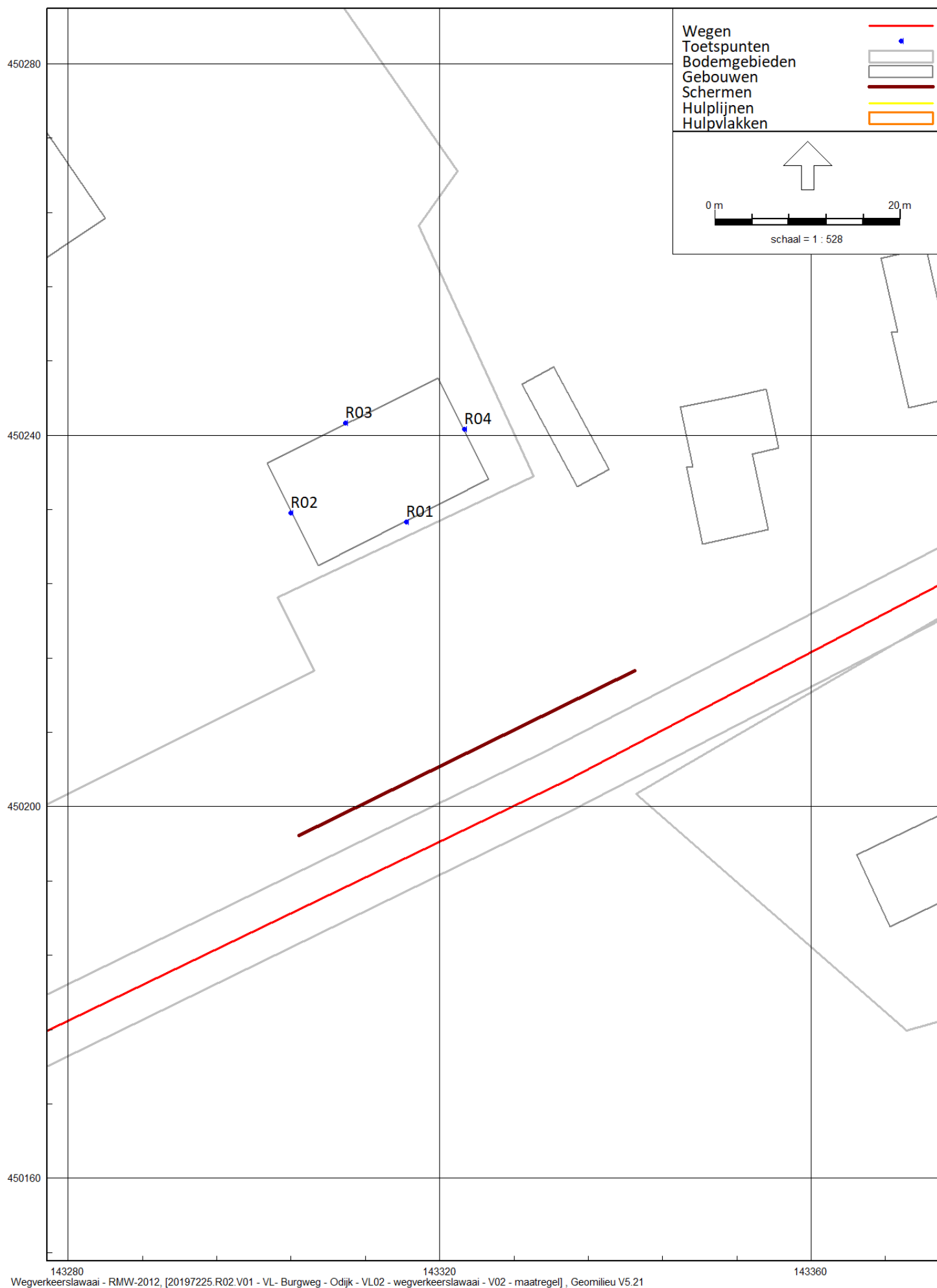
Figuur 5 | Mogelijke overdrachtsmaatregel: Geluidsscherm 1,0 meter hoog, circa 40 meter lang.
