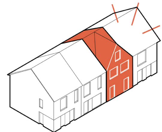
Onderbreking gootlengte door nokverdraaiing
