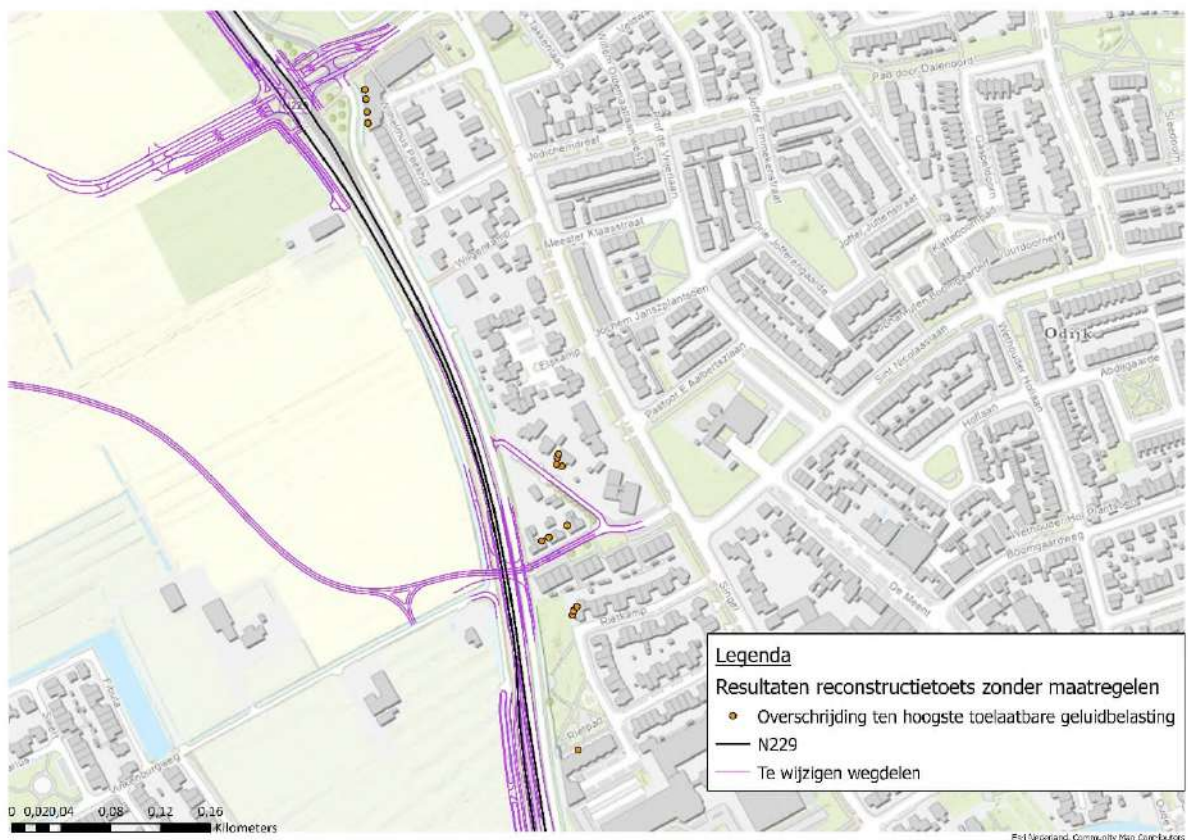
Figuur 4.1 Rekenpunten met een reconstructie in de zin van de Wet geluidhinder als gevolg van de wijzigingen aan de N229.
