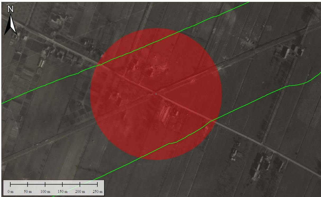
Figuur 46. De risicostraal van 189 meter ter plaatse van de spoorwegovergang bij Groenekan.
