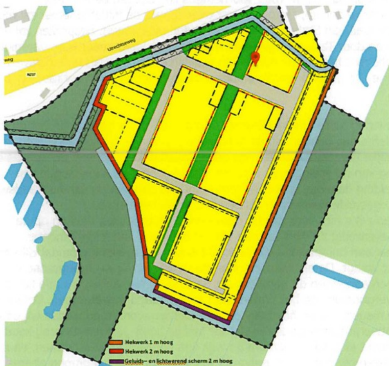
Afbeelding 1 Wijze van overname hekwerk uit aanbeveling b met onderscheid in hoogte en met geluids- en lichtwerend scherm.
