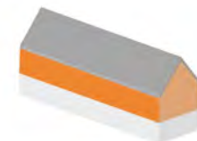
Eerste laag in baksteen, rest in hout
