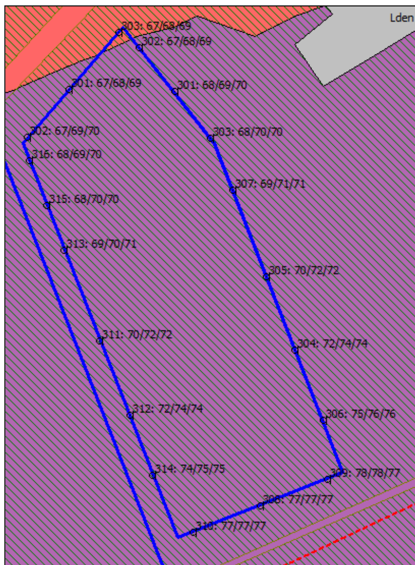
Figuur 7.2a: Geluidscontouren op 4 m en geluidswaarden op 1,5/4,5/7,5 m op grens bebouwing locatie 3 (spoorwegverkeer)
