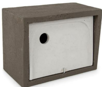
NK MU 07 Inbouwsteen Mus (nieuwbouw) 290 x 240 x 190mm Plaatsing in noord/oostgevels en geschikt voor huismussen/ringmussen/mezen inbouwhoogte minimaal 3 meter
