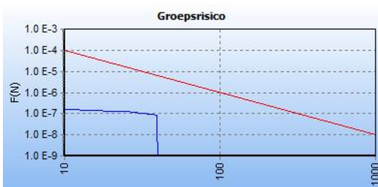
Afbeelding 6 fN-curve buisleiding A-510-01-deel-1, huidige situatie
