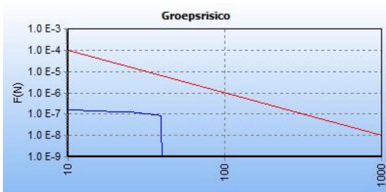
Afbeelding 7 fN-curve busleiding A-510-01-deel-1, toekomstige situatie
