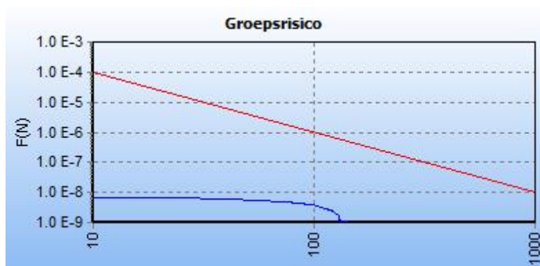
Afbeelding 11 fN-curve buisleiding WV-500-01-deel-1, huidige situatie
