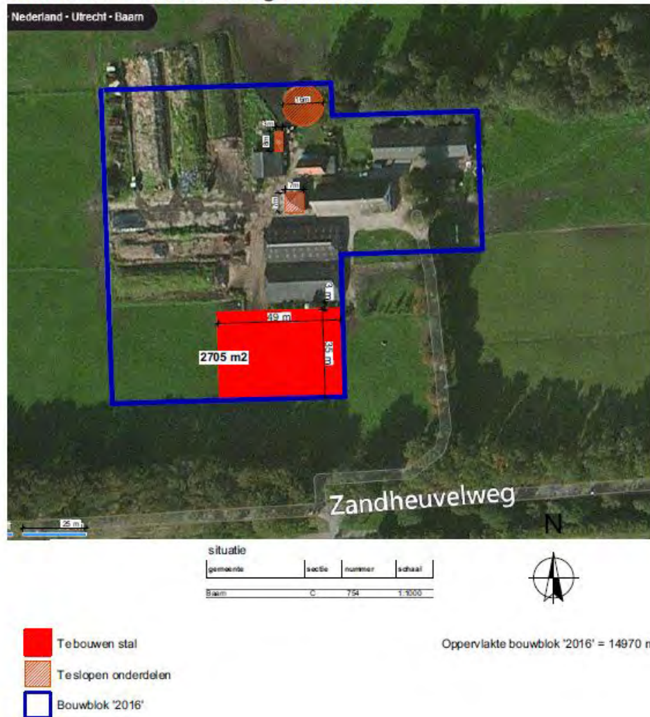
Figuur 4. Bouwblok Zandheuvelweg 2 (nieuwe situatie)
