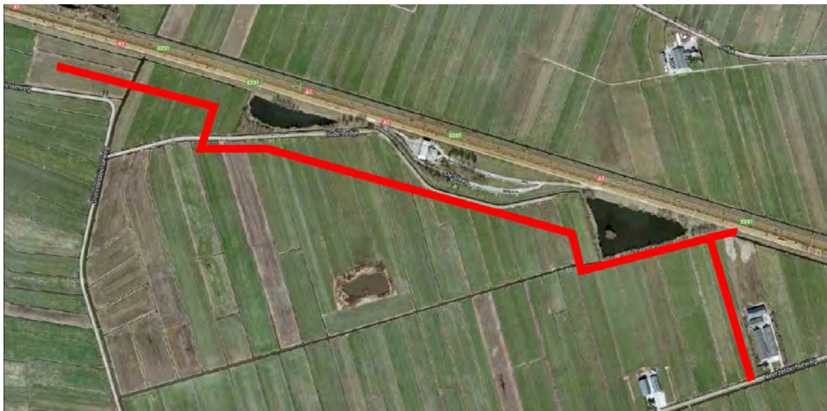
Figuur 2. Luchtfoto buitengebied tussen Baarn en Amersfoort met nieuw tracé gasleiding en toevoerroute / werkterrein.
