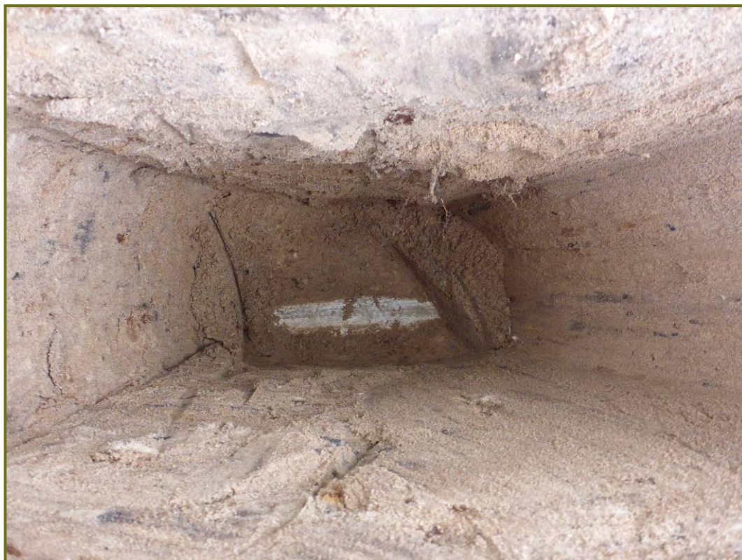
Afbeelding 15. Profielkuil 3 geen wortels wel leiding op -80 cm
