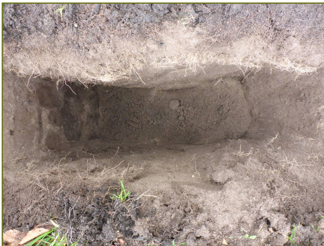
Afbeelding 13. Profielkuil 2 nauwelijks wortels aanwezig
