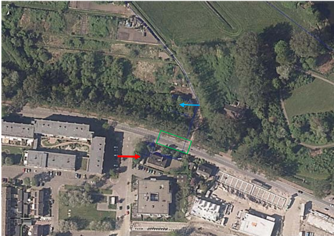
Figuur 2. Bestaande situatie GOS terrein (rode pijl) met in blauwe lijnen de nieuwe bekabeling; blauwe pijl geeft locatie nieuwe GOS aan; onderzoeksgebied in de groene recht (bron: bing maps)
