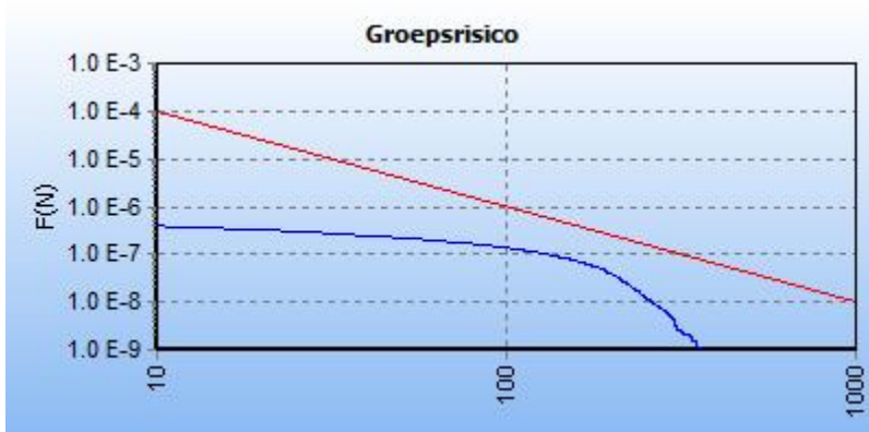
5.2 Figuur 5.2 FN curve voor 4813_leiding-W-500-01-deel-1 van N.V. Nederlandse Gasunie voor de kilometer tussen stationing 3280.00 en stationing 4280.00
