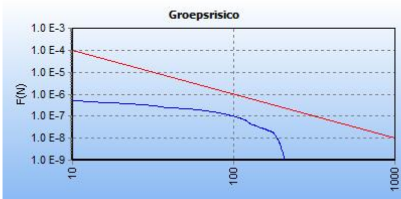
5.2 Figuur 5.2 FN curve voor 4813_leiding-W-500-01-deel-1 van N.V. Nederlandse Gasunie voor de kilometer tussen stationing 3280.00 en stationing 4280.00
