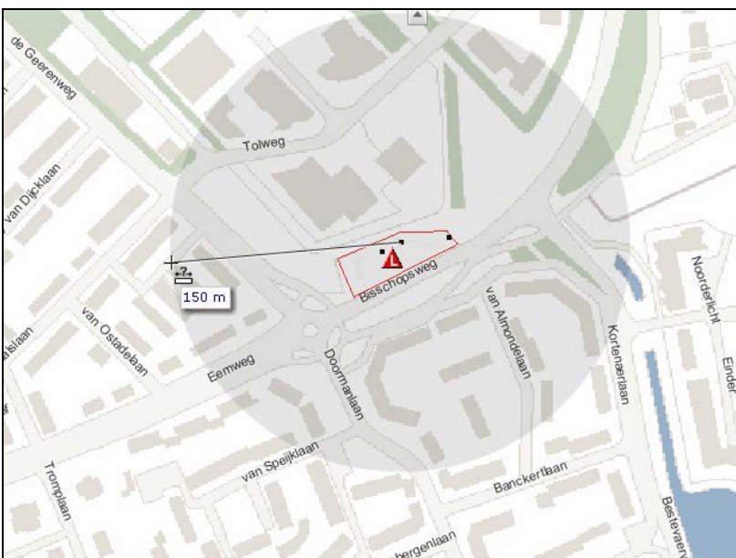
Figuur 4: invloedsgebied vanaf het LPG reservoir vanaf het LPG tankstation aan de Eemweg 25
