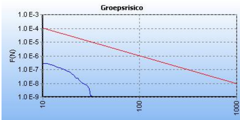
5.2 Figuur 5.2 FN curve voor W-500-01 van N.V. Nederlandse Gasunie voor de kilometer tussen stationing 14370.00 en stationing 15370.00
