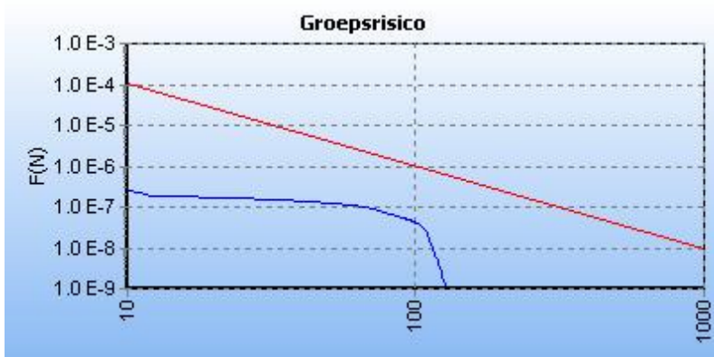
5.2 Figuur 5.2 FN curve voor W-500-01 van N.V. Nederlandse Gasunie voor de kilometer tussen stationing 14370.00 en stationing 15370.00
