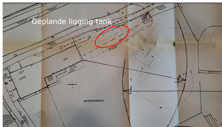
Figuur 6: tekening vergunningaanvraag dieseltankinstallatie (1987)
