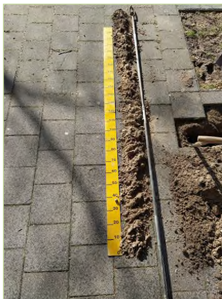
Profielboring bij boom 3.
