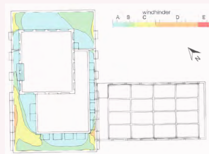
Figuur 5.5: Windklimaat op dakvlakken plint van plan Utrechtseweg 2-4
