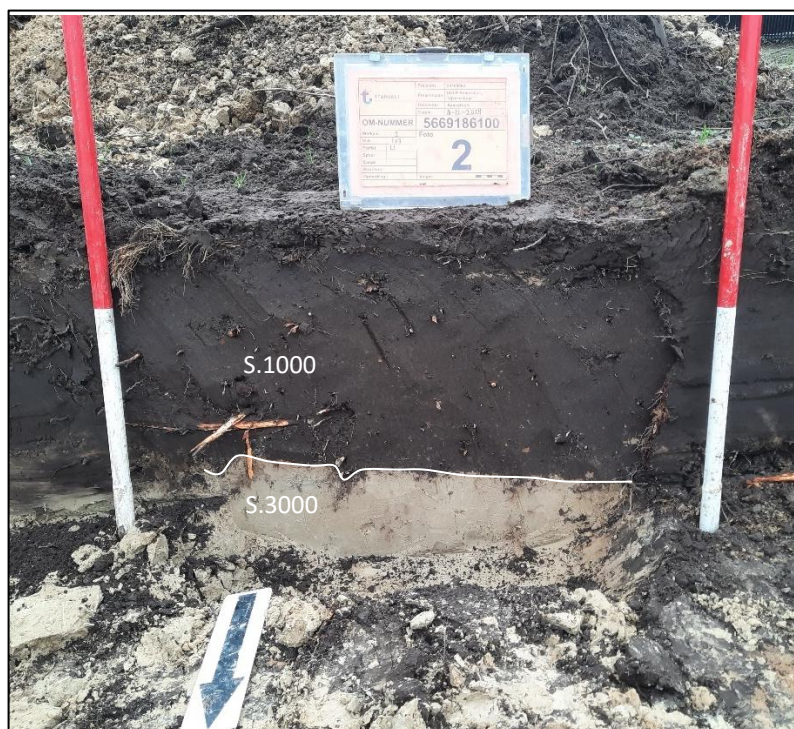
Figuur 3. AC-profiel in werkput 1 (profiel 1.1). Het bouwlanddek ligt direct op het dekzand, zonder bodemvorming.
