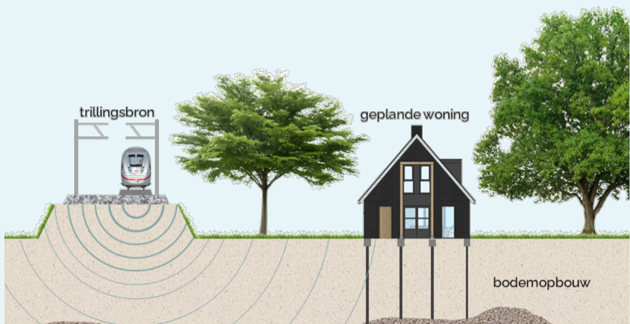
Figuur 3 Trillingen gaan vanuit de trillingsbron, via de bodem naar een gebouw toe. De hoogte van de trillingen in het gebouw zijn afhankelijk van zowel de trillingsbron, de bodemopbouw als de constructie van het gebouw
