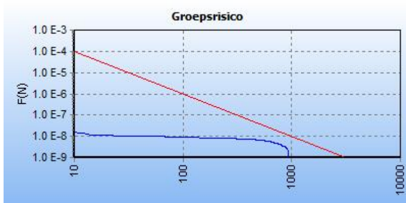
5.1 Figuur 5.1 FN curve voor 6464_leiding-A-510-deel-1 van N.V. Nederlandse Gasunie voor de kilometer tussen stationing 1860.00 en stationing 2860.00
