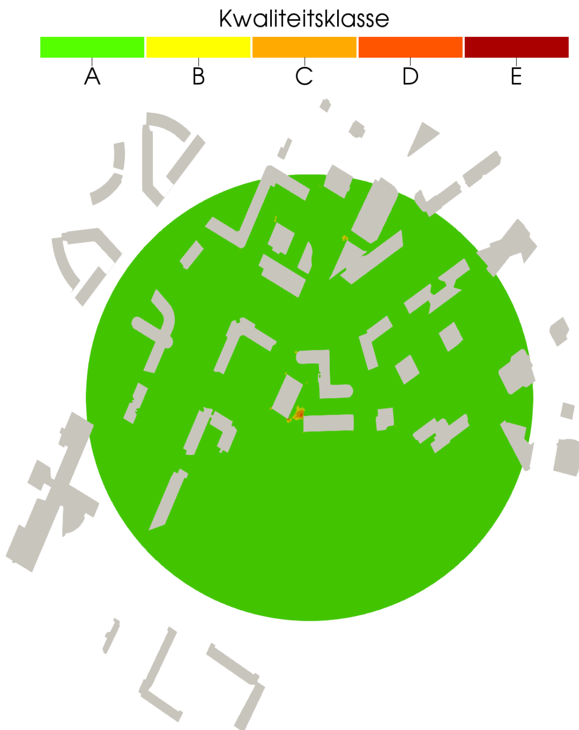
Figuur 5-2. Kwaliteitsklasse van windklimaat conform NEN 8100 op loopniveau (1,75 m hoogte); bovenaanzicht.
