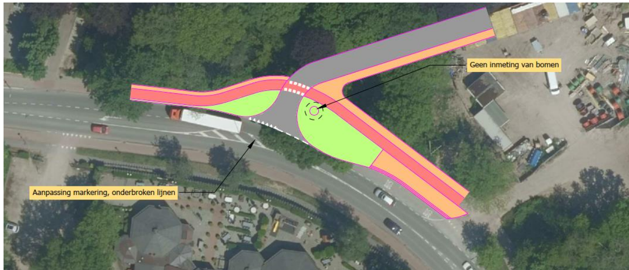
Figuur 3-3: ontwerp aansluiting op BW-laan: variant met uitgebogen fietspad.
