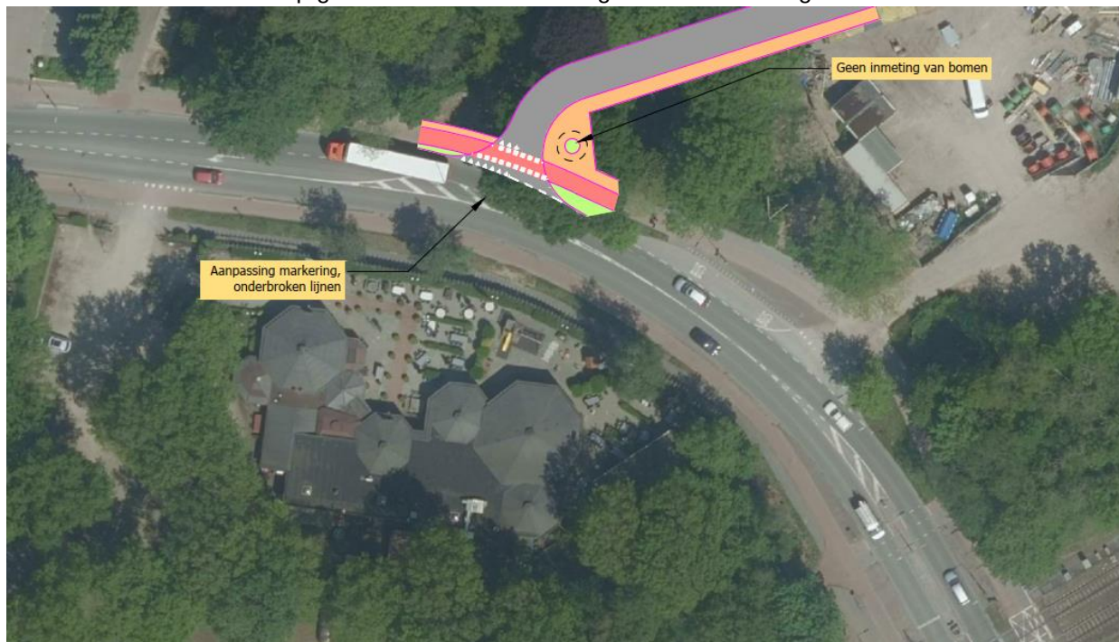
Figuur 3-1 Schetsontwerp aansluiting naar bewonersgarage op BW-laan
