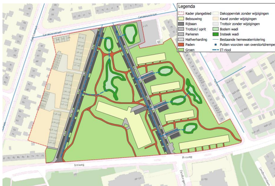
Figuur 4-1: Schematisch overzicht waterbergende voorzieningen binnen plangebied
