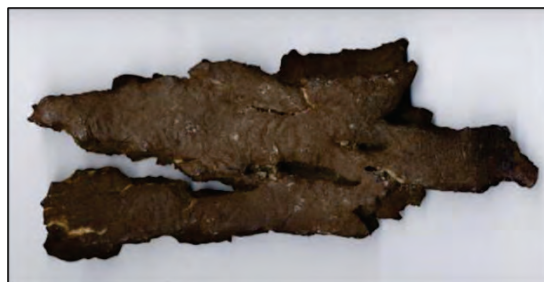
Afb. 3.4.8. - scherf door detonatie
