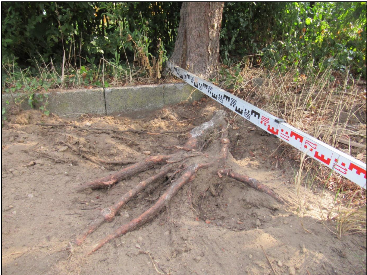
Foto 13: oppervlakkige beworteling boom 4, ter plaatse van aan te leggen parkeervakken
