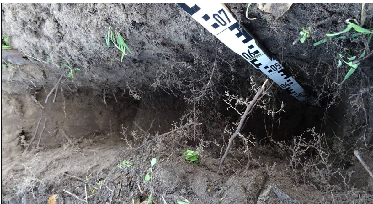
Foto profielkuil binnen de kroonprojectie van de gewone esdoorn. Van 0 tot 40 cm beneden maaiveld is een intensieve overwegend fijne beworteling aangetroffen.
