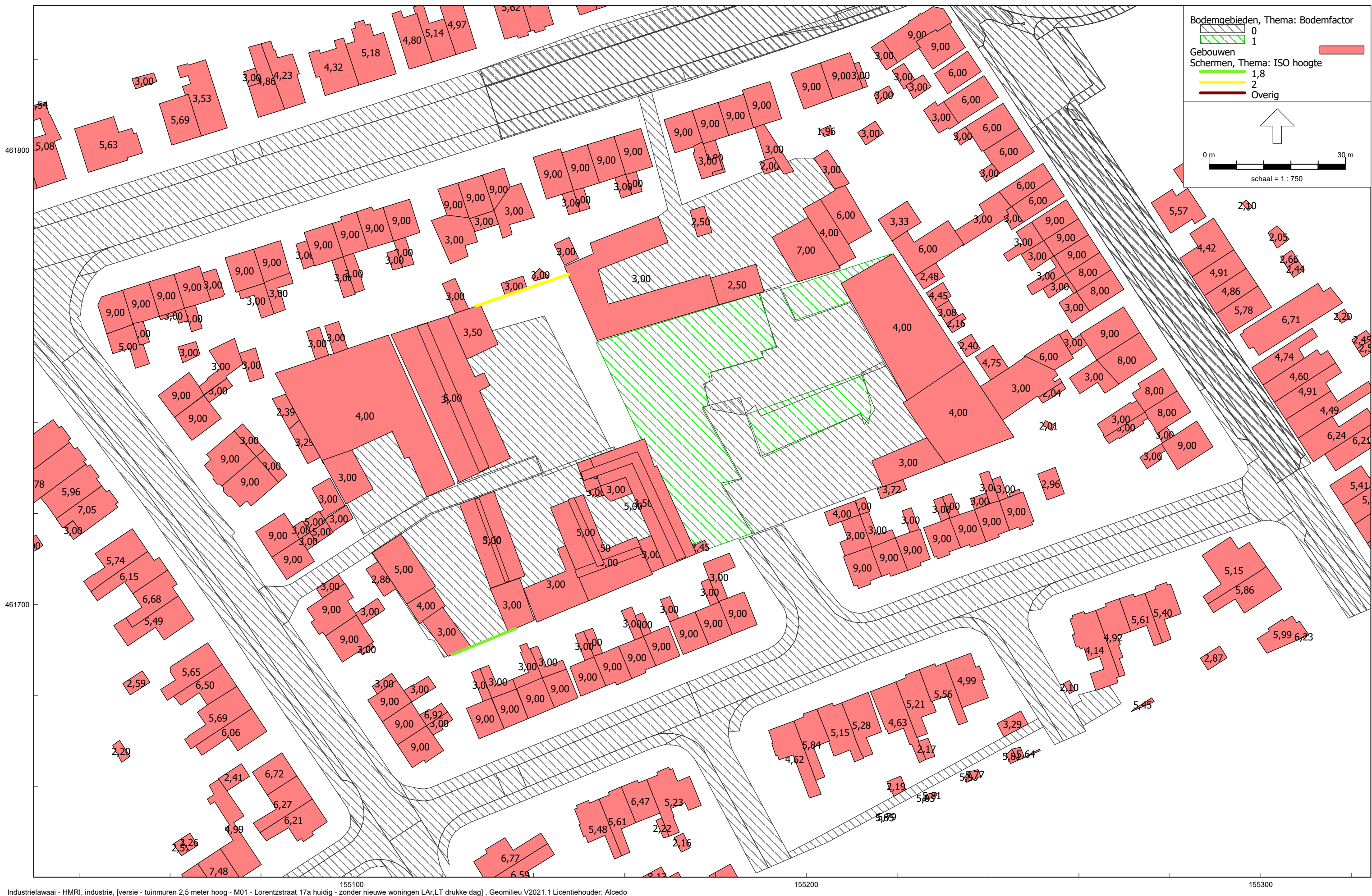
Figuur 3 Overzicht rekenmodel huidige situatie met gehanteerde gebouwhoogten en bodemfactoren
