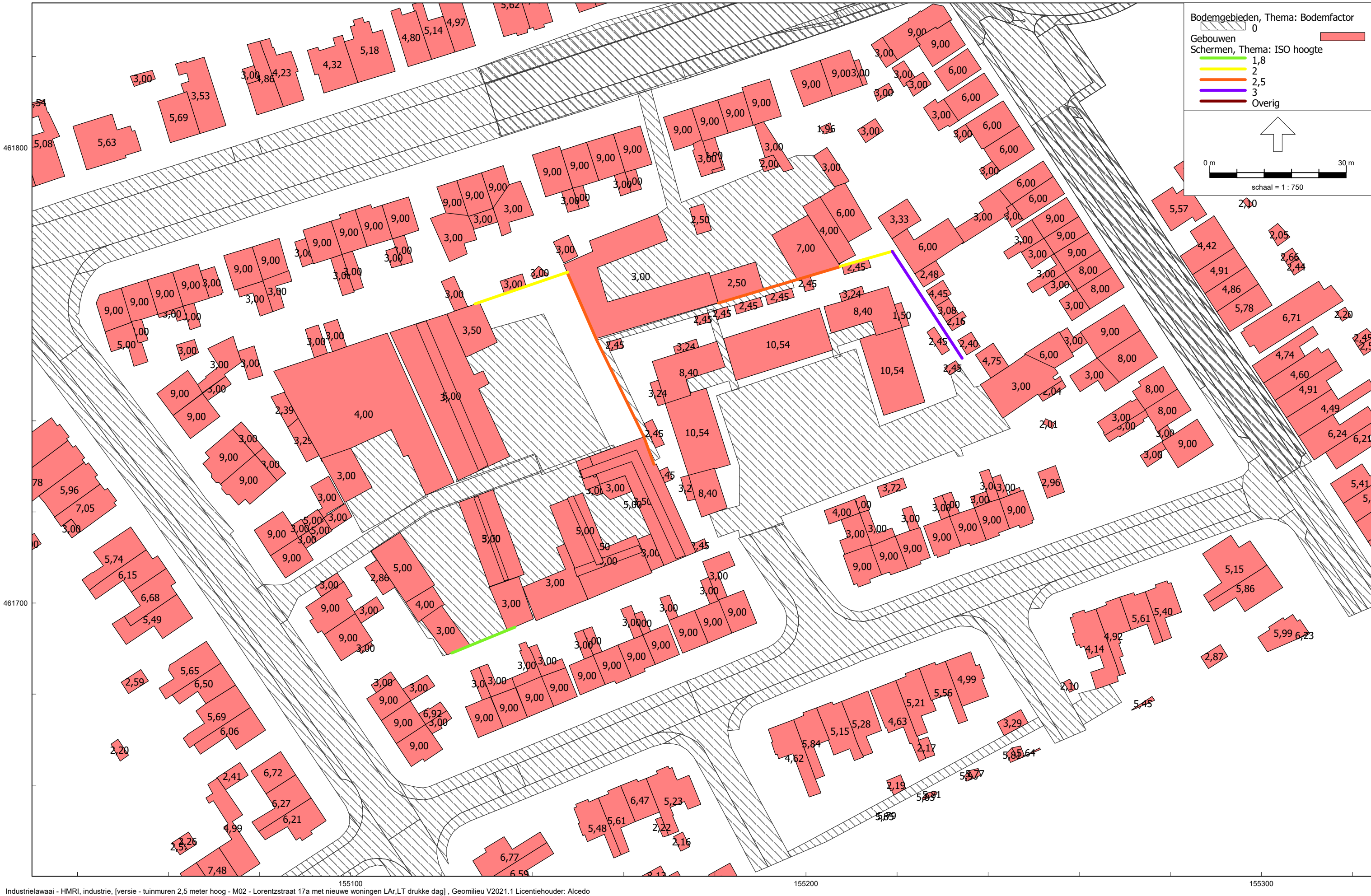
Figuur 4 Overzicht rekenmodel toekomstige situatie met gehanteerde gebouwhoogten en bodemfactoren
