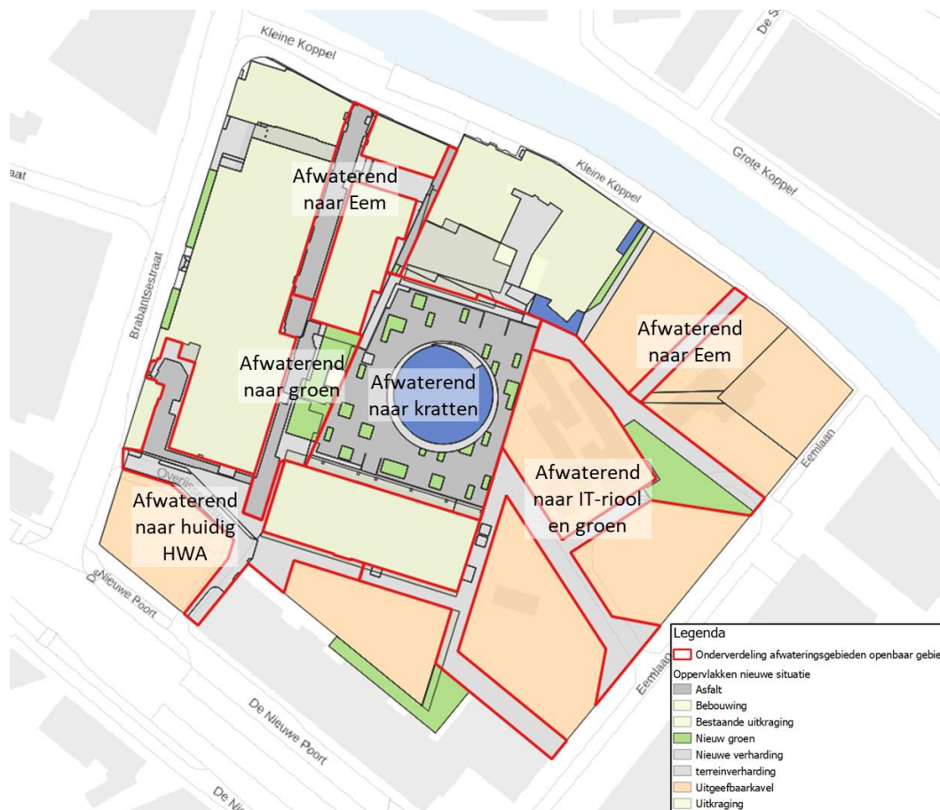
Figuur 4-2: Onderverdeling afwateringsrichtingen openbaar terrein
