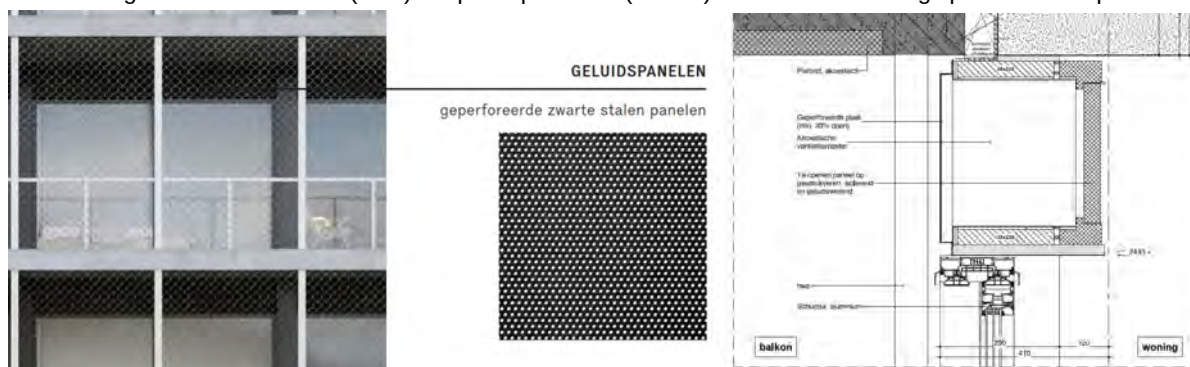
Afbeelding 2: Gevelaanzicht (links) en principedetail (rechts) muurrooster met geperforeerde plaat.
