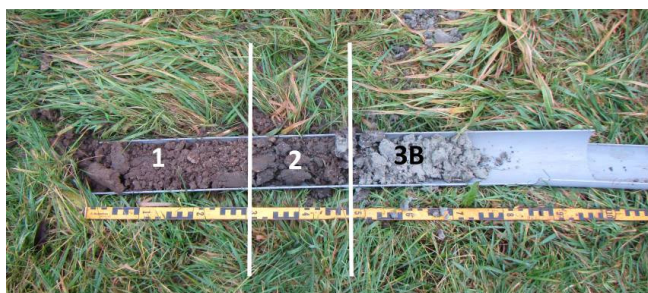
afbeelding 8, boring 03: een bouwvoor (1), op een kleilaag (2), op lichtgrijs, lichtlemig dekzand (3B).
