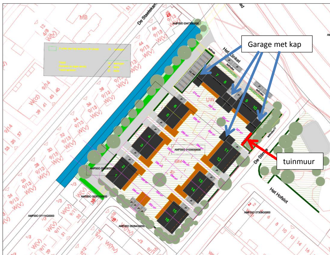
Figuur 2 Aangepast ontwerp met woning 7 t/m 11 garage met kap 5 meter hoog en tuinmuur bij woning 10, absorberend uitgevoerd en hoogte 2 meter
