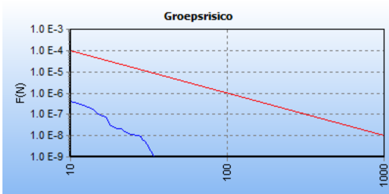
5.2 Figuur 5.2 FN curve voor 3587_leiding-W-520-05-deel-1 van N.V. Nederlandse Gasunie voor de kilometer tussen stationing 810.00 en stationing 1810.00
