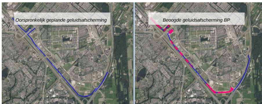
Figuur 3.1: Oorspronkelijk geplande geluidsafscherming en beoogde geluidsafscherming conform het bestemmingsplan (blauw geluidsschermb/geluidswal en roze, afschermende bebouwing met een minimale bouwhoogte van 15 meter)
